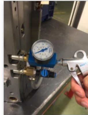
Ein Rückschlagventil verhindert das Zurückweichen der eingeblasenen Druckluft.
