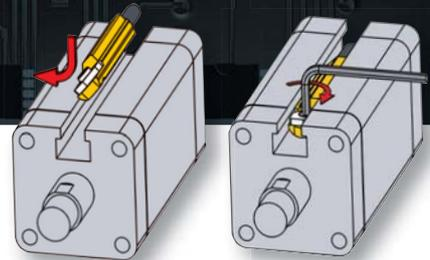
Dank der spannungsfreien Befestigung ist eine Zerstörung des Sensors durch zu festes Anziehen der Befestigungsschraube ausgeschlossen.
