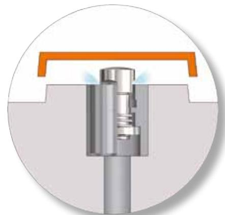
Bild 6: Mit beginnender Entformungsphase öffnet das Ventil, die Druckluft strömt durch die Austrittsbohrungen. Durch diese Belüftung wird ein sicheres Entformen besonders von großvolumigen, flächigen Teilen erreicht
