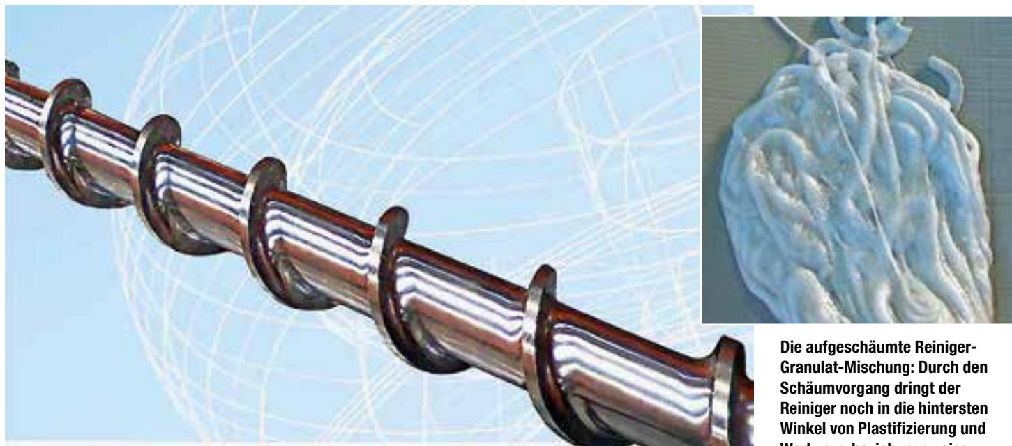
**Saubere Schnecke: Die Alternative zur chemischen Schneckenreinigung liegt im aufwendigen und zeitraubenden Schneckenausbau und deren mechanischer Reinigung** Foto: Gmhofmann
