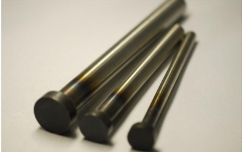
Mit einem patentierten Verfahren sind wir ebenfalls in der Lage, Auswerferhülsen in jeder beliebigen Länge auf Basis des bekannten Standardprogrammes zu produzieren. Die Führungslänge der Auswerferhülse bleibt dabei unverändert !
